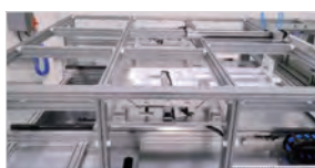
1. アルミ枠が分離されたパネルガラス分離パートに自動運搬
